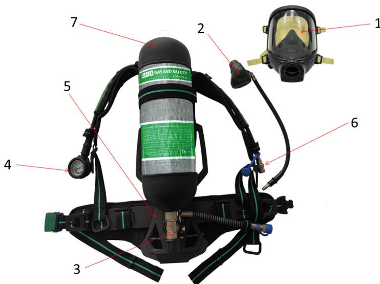
O ar deve ser armazenado no cilindro (pressão de 30MPa) do SCBA usando o método de compressão de ar; o ar de alta pressão deve ser transmitido para o tubo intermediário após ser submetido à redução primária de pressão para  $(0,75 \pm 0,15)$  MPa usando o redutor e o ar de pressão positiva deve ser fornecido ao usuário usando a máscara após a redução secundária de pressão usando a válvula de demanda.
