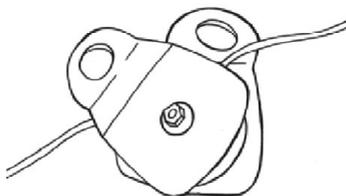
6. Libere cerca de 3 m de cabo de aço do sistema guincho (desenrolando-o através de sua manivela) e passe o mesmo pela roldana (não esqueça de exercer tração no cabo do mesmo durante o desenrolar, para que ele não "trave").
